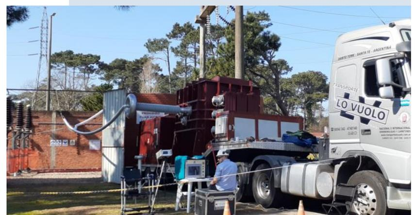
PUNTA DEL ESTE - URUGUAY - (SAT) ENSAYOS DE ACEPTACION CABLES CLASE 150KV (IEC60840-2011)
