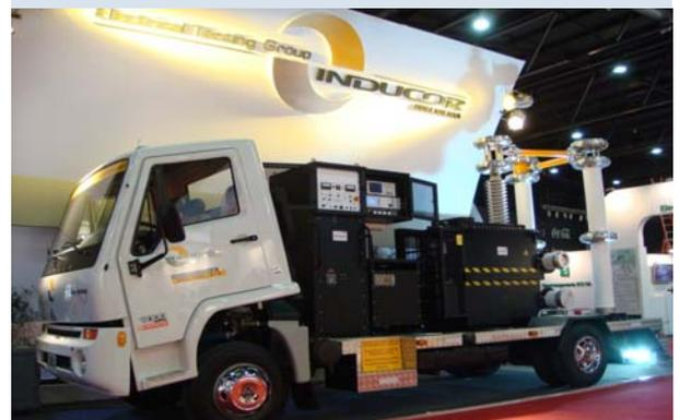
1º SISTEMA MOVIL PARA DIAGNOSTICO DE CABLES DE 132 Y 220KV
