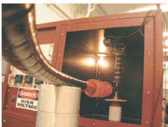
Moderno e independiente laboratorio de ensayos de MT/AT, dedicado a la evaluación de cables de energía y sus accesorios.
