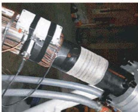
El estado de los terminales de un cable polimérico de MT/AT, puede también ser evaluado en forma on-line. Las descargas parciales se pueden medir localmente utilizando sensores VHF ubicados en el área de baja tensión del terminal.
