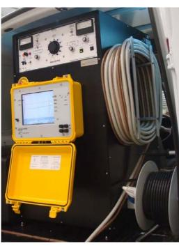
Unidades diseñadas para uso continuo, con fuente de AT tipo transformador convencional compensado. (No posee fuentes electrónicas de alta HF (osciladores de 50 kHz), que no permiten su uso confiable cuando se alimenta al sistema mediante grupos electrógenos, o ante fallas de difícil o extensa detección).
