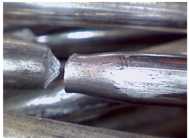
FRACTURA DUCTIL EN EL INSTANTE DE CORTE
