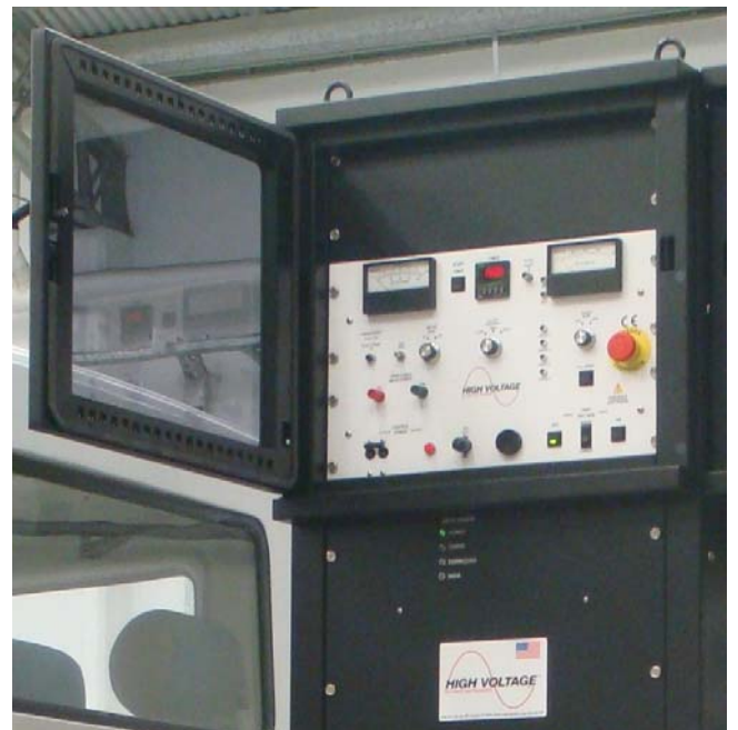
Panel de Control de tensión/corriente del VLF-200 HVCD
