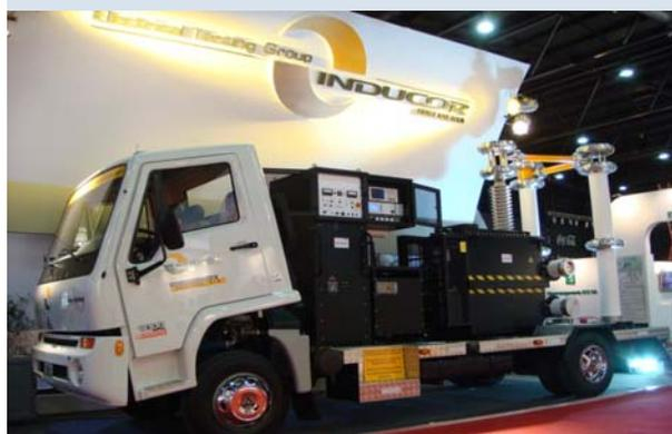
1º SISTEMA MOVIL PARA DIAGNOSTICO DE CABLES DE 132 Y 220KV
