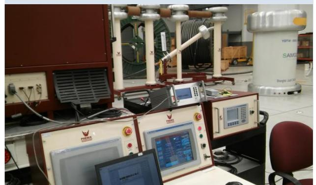
LABORATORIO UTNLAT-INDUCOR ENSAYOS DE RUTINA SEGUN IEC60840-2011 CABLES 132KV
