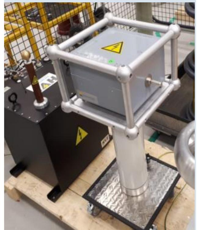
ABB - LABORATORIO DE DESCARGAS PARCIALES EN RECONECTADORES (IEC3760-2012)
