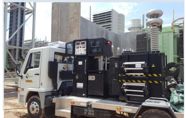
NUEVA CENTRAL TERMoeLECTRICA SAN PEDRO - ENSAYOS DE ACEPTACION CABLES CLASE 132KV
