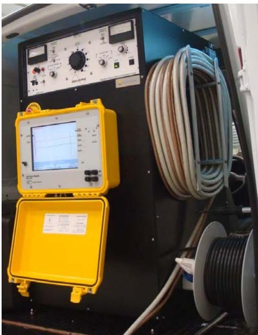
Unidades diseñadas para uso continuo, con fuente de AT tipo transformador convencional compensado. (No posee fuentes electrónicas de alta HF (osciladores de 50 kHz), que no permiten su uso confiable cuando se alimenta al sistema mediante grupos electrógenos, o ante fallas de difícil o extensa detección).
