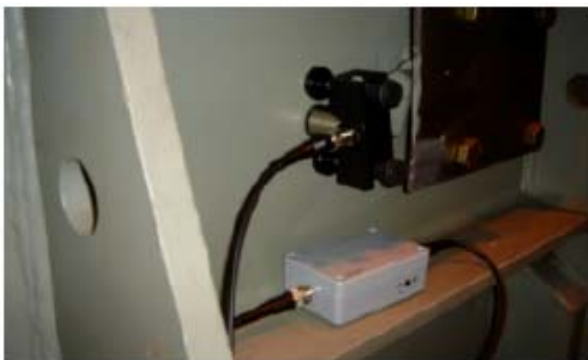
Fig. 9- Sensor acústico, fixture y preamplificador RPA1D.
