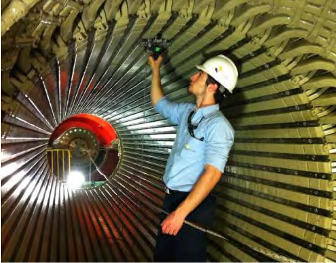
Algunos paquetes laminares presentan defectos menores en la parte superficial de los dientes hacia la parte media e inferior del núcleo del estator, mientras que algunas ranuras presentan valores picos no representativos, ocasionados por un error en la manipulación de la bobina Chatock durante el censado.
