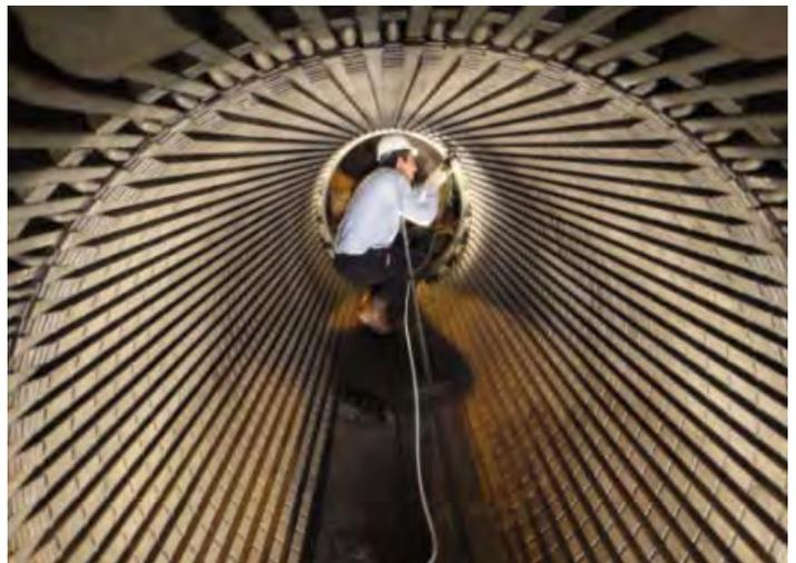
Para obtener y establecer un índice del estado del núcleo del estator, existen dos metodologías para verificar la correcta aislación entre chapas del mismo:
