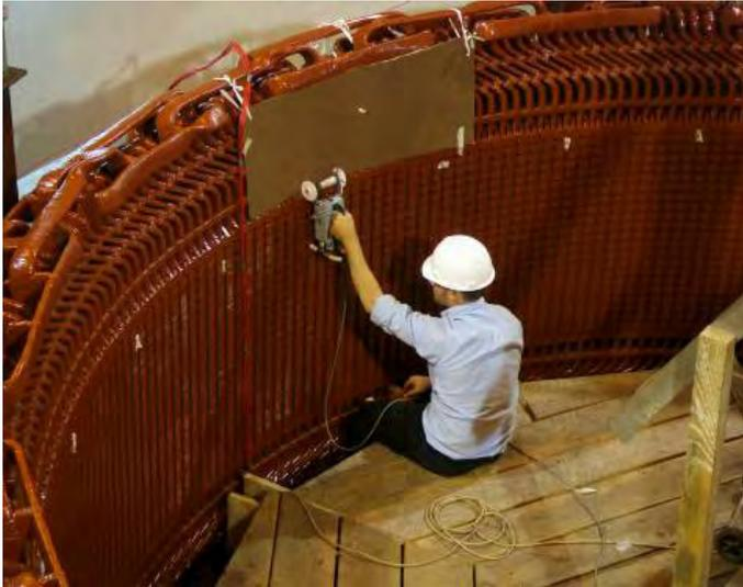
puede estar en corto circuito, no así la zona adyacente a las ranuras. Los extremos del núcleo se sujetan mecánicamente por lo que se conoce coloquialmente como “dedos de sujeción”. Se debe evitar que haya puntos adicionales de conexión o contacto entre láminas, para evitar la inducción de corrientes parásitas que podrían generar concentraciones puntuales de calor adicional, contribuyendo al deterioro de la aislación del bobinado estático.
