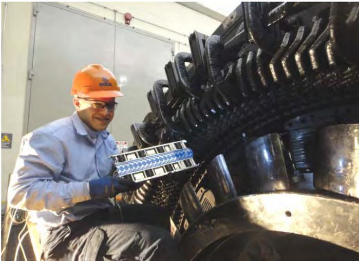
Sin necesidad de extraer su rotor, el reducido perfil del sistema es capaz de desplazarse mediante sujeción magnética controlada, por los limitados espacios del entrehierro de un hidrogenerador, sin necesidad de extraer su rotor, mientras que un poderoso registrador de 500kc/s de sampleo dinámico, con pantalla de 8,4” SWGA-TFT y operación Touch-Screen, permiten un escaneo preciso, identificación y estudio de los mas
