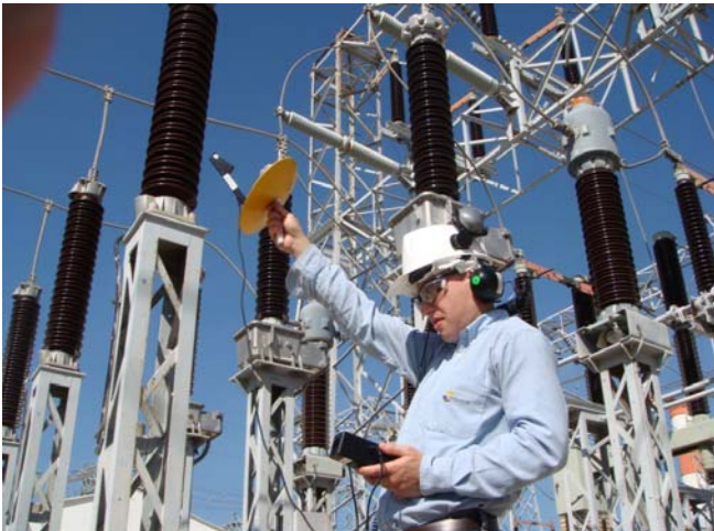
ESCANEO ACUSTICO DIRECCIONAL DE UNA S.E.
