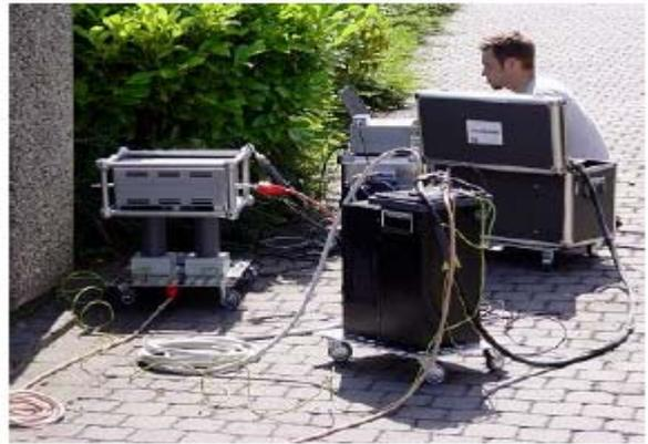
Figura 11: Sistema TCC45 Power Diagnostix, con una unidad VLF de 60kV marca HIGH VOLTAGE Inc.
