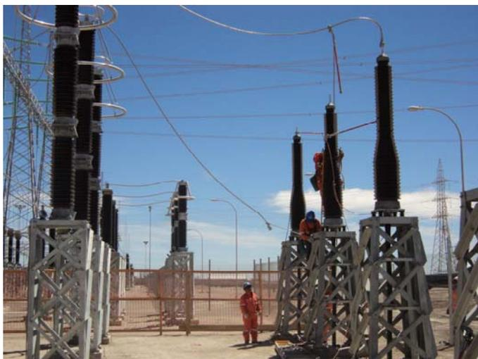
A diferencia de este ensayo de tensión resistida del tipo monitoreado, el caso anterior, (sin monitorear), se lo ha pasado a llamar: **Ensayo de Tensión Resistida Simple** (Simple Withstand Test), o sea a aquel ensayo, en donde la tensión a aplicar (en un valor determinado), es establecida durante un tiempo (predeterminado también), y si el objeto bajo ensayo sobrevive, entonces se lo dará simplemente como superado.
