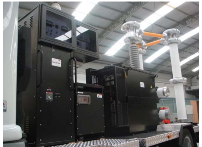
Unidad móvil VLF-200 HVCD, de 220 kv con capacidad de ensayos de Tangente Delta /Descargas Parciales (INDUCOR INGENIERIA S.A.)
