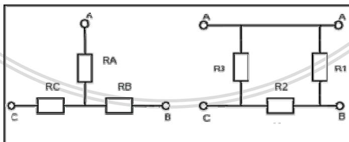
Las ecuaciones de equivalencia entre ambas asociaciones vienen dadas por el [teorema de Kenelly](#), de donde se deduce que los valores de la estrella en función de los del triángulo (transformación triángulo a estrella) son:
