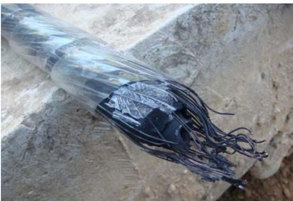
Técnicamente, para conformar un capacitor cilíndrico ideal, un cable polimérico de triple extrusión consiste en 3 capas, en donde la aislación principal de XLPE es terminada en ambos lados con una fina capa de material polimérico semiconductor.
