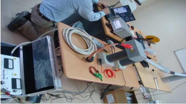
Una descarga de 100 pC, que se repite una vez cada 30 seg., es menos peligrosa que una de 50 pC, pero que se repite 10 veces por cada segundo. Aquí el factor en juego, es el efecto calor (dentro de la aislación) generado por las descargas, y éste se encuadra en función directa con la frecuencia de repetición.
