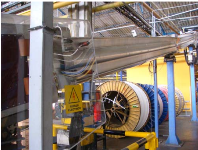
IMAGEN DE UN MODERNO TUBO DE VULCANIZADO
