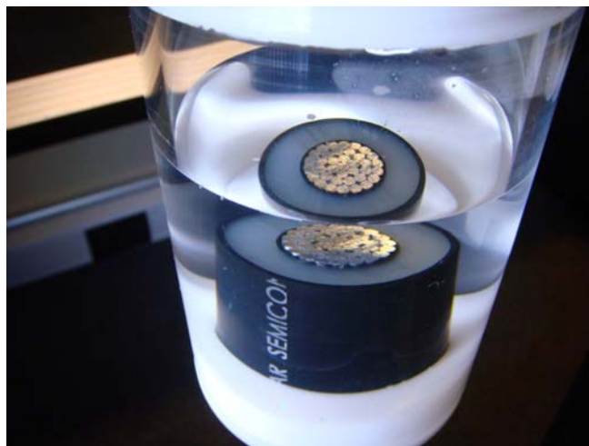
PROBETA DE EXTRACCION DE GASES DEL XLPE
