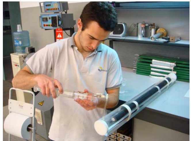
PROBETA DE EXTRACCION DE GASES DEL XLPE PARA CROMATOGRAFIA GASEOSA
