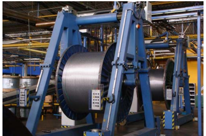
FORMACION DE BOBINAS MADRES LUEGO DE EXTRUSION
