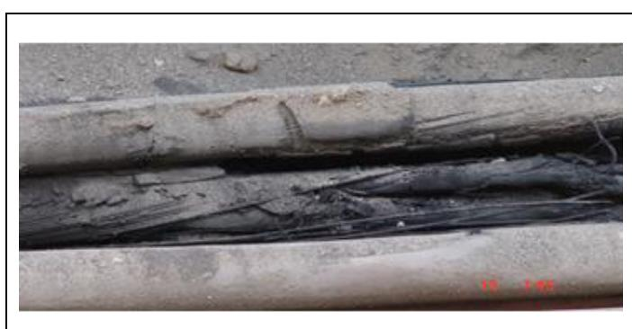
Esto lógicamente tiene una explicación, y esta basada en que a 0,1 Hz, y a  $V = 3 U_o$ , de tensión aplicada, el radio de crecimiento de las ramificaciones de descargas internas de un cable (trees), es de 10,9 a 12,6 mm/h (milímetros por hora); lo cual es casi cinco veces mayor que a 50Hz.
