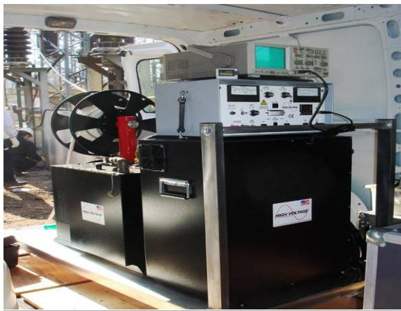
La bondad de un equipo para ensayos en VLF, es la de aproximarse lo mas posible a un ensayo efectuado en corriente alterna a la frecuencia de red, pero la diferencia sustancial radica en la baja potencia que requiere el modo VLF (0,1 Hz), frente al anterior de 50 Hz o 60 Hz.
