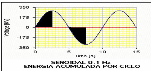
Claro que cargar un cable con corriente continua es muy sencillo y requiere de una fuente de poca potencia, pero el principal problema está en los intervalos de descarga de la gran energía acumulada en dicho cable, según la ecuación:
