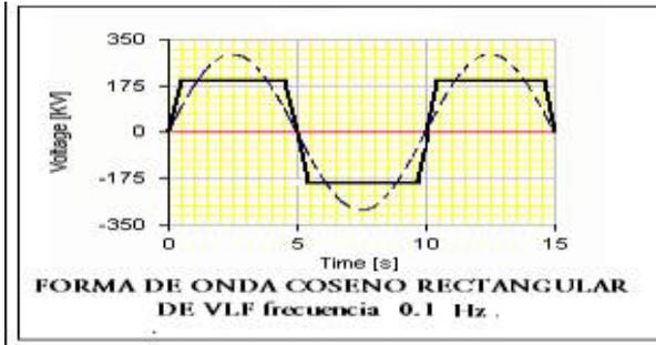
Por el momento, ninguna tecnología ha logrado obtener una forma de onda estrictamente senoidal de generación de alta tensión en VLF, consiguiendo solo hasta el momento, y dependiendo de las marcas comerciales, señales del tipo cuadradas, coseno-rectangulares, rectangulares bipolares, saltos de tensión, etc.
