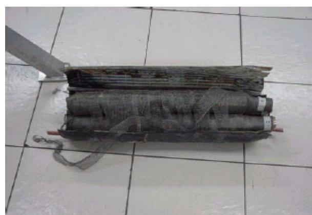
Al retirar los elementos de ensamble, se puede observar que uno de los conductores de tierra estaba fuera del conector de compresión, lo cual sería indicativo de una compresión deficiente pero que no se puede relacionar con la falla en estudio.
