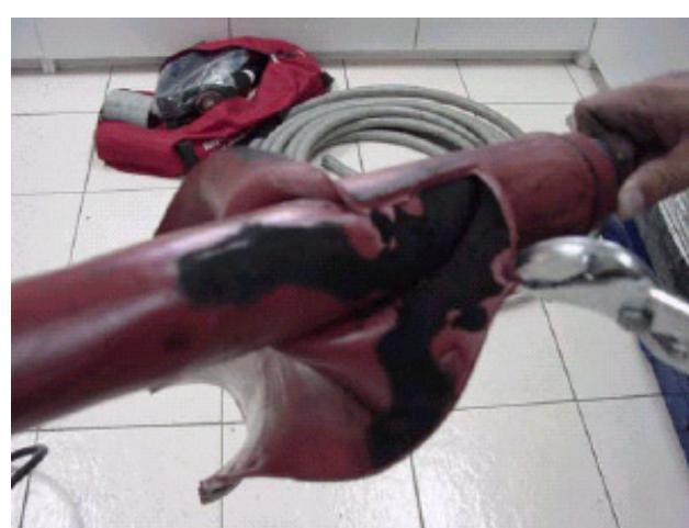
Esto originó una pérdida relativa del aislamiento en la "vela" del conductor (distancia longitudinal que se deja con el aislamiento original del cable, y que va desde el corte de la semiconductora hasta el conector de compresión cubierto por mastic amarillo).
