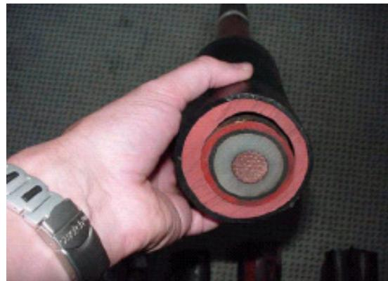
Analizando la fase fallada, se puede apreciar que el tubo elastomérico de dos colores (negro/rojo), no fue adecuadamente termocontraído, quedando una cavidad de aire en la zona central del empalme.
